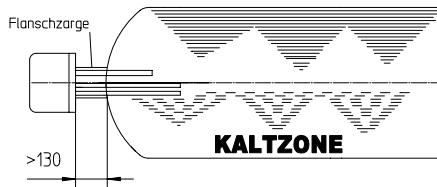
Die Flanschzarge darf nicht länger als max. 130 mm sein, damit Temperaturfühler und Heizkörper noch ausreichend in den Kessel hineinragen.
