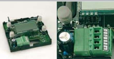
1 detajli elektronike v notranjosti termostata K481
