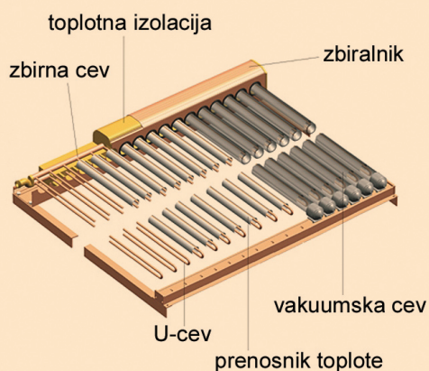
ZGRADBA U-CEVNEGA KOLEKTORJA
